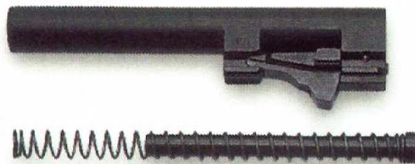
Nella parte posteriore della canna (detta culatta) sono solitamente predisposte lavorazioni per la corretta chiusura meccanica dell'arma al momento dello sparo e/o particolari congegni che servono a ritardarne l'apertura e permettere lo scorrimento del carrello otturatore, sia nella fase di arretramento per l'espulsione del bossolo, sia in quella di ritorno per la chiusura.
