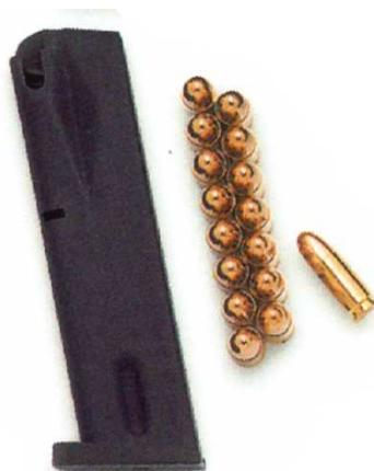
È detto anche serbatoio di alimentazione in quanto contiene le cartucce e le presenta sul piano d'invito, con spinta verso l'alto dovuta alla forza della molla.
