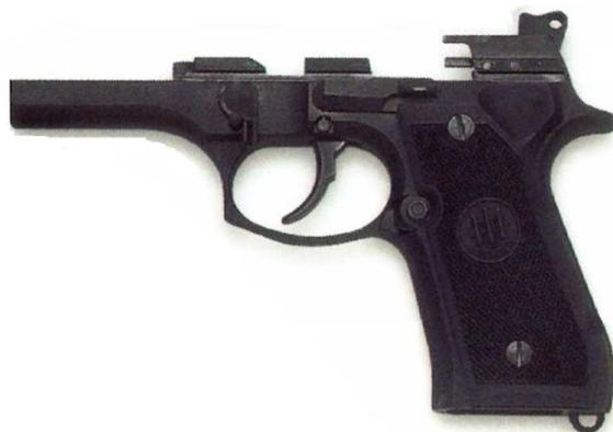
Permette l'assemblaggio delle varie parti dell'arma. nelle armi corte l'impugnatura è parte integrante del fusto o castello, consentendo, quindi, all'operatore un agevole maneggio. nelle armi automatiche o semiautomatiche, al suo interno, trovano posto, solitamente, i meccanismi di scatto, il caricatore e altri congegni necessari all'assemblaggio con le altre parti dell'arma.
