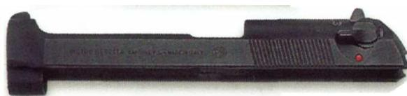
Assicura la chiusura posteriore della canna, mantenendo la munizione nella camera di cartuccia. nelle armi semiautomatiche o automatiche sull'otturatore agisce anche la molla di recupero, che lo riporta in chiusura dopo ogni sparo.
